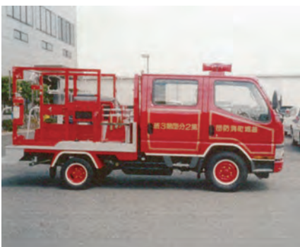
小型動力ポンプ積載車
