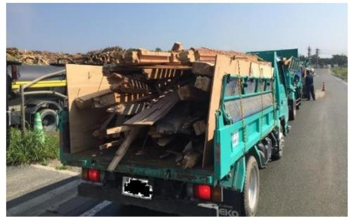
飛散防止措置が不十分な運搬車両
