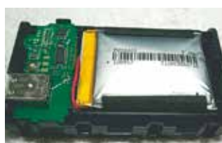
劣化して膨らんだバッテリー
