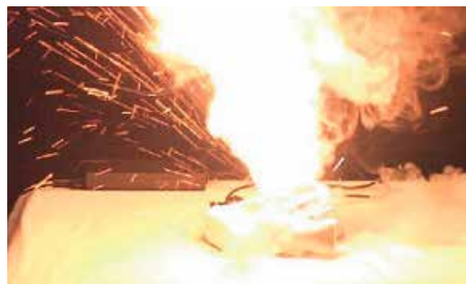
衝撃を与える実験で激しく発火するバッテリー
