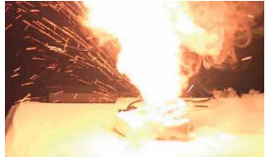
衝撃を与える実験で激しく発火するバッテリー
