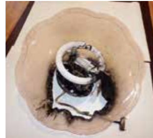
コンデンサーから出火した照明器具
