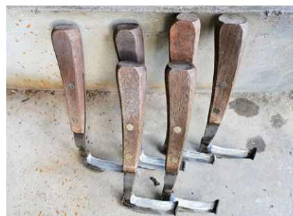
牛のひづめを整える時に使う、独特の形をした道具
