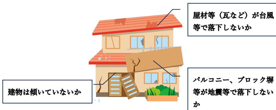
倒壊等著しく保安上危険となるおそれのある状態
