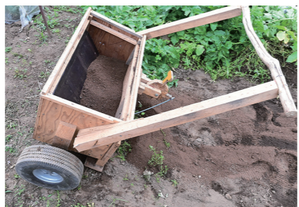
矢野さんが手作りした手押し式肥料散布機
