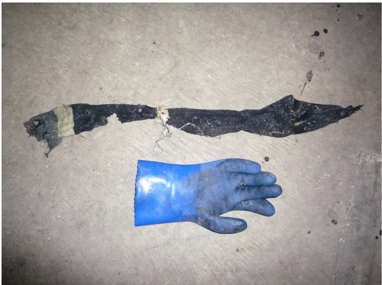
●町浄化センター内における異物混入例（ゴム手袋・布製品）
