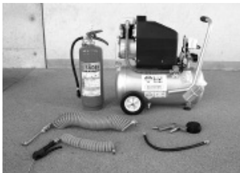
整備された消火訓練用放射器セット
